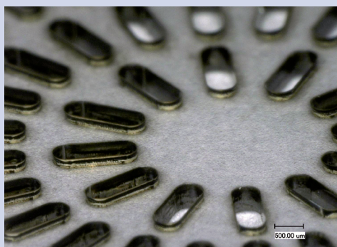
Detailausschnitt eines Kunststoff-Layers (Dicke 500 Mikrometer) für Zell-Wachstumsversuche
